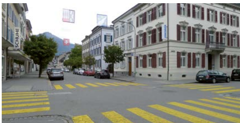
Strisce pedonali non arretrate: in alto, su una strada con obbligo di precedenza; in basso, su una strada con precedenza a destra.
