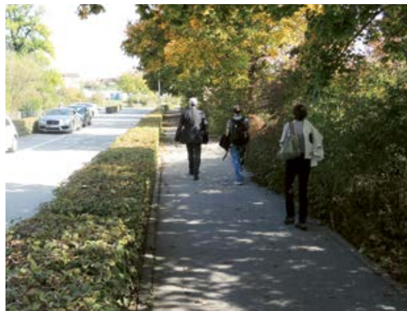
Corsia pedonale separata da una siepe.
