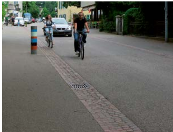
Separare la sede pedonale dalla carreggiata con una canaletta scorriacqua è indicato in vie poco trafficate.
