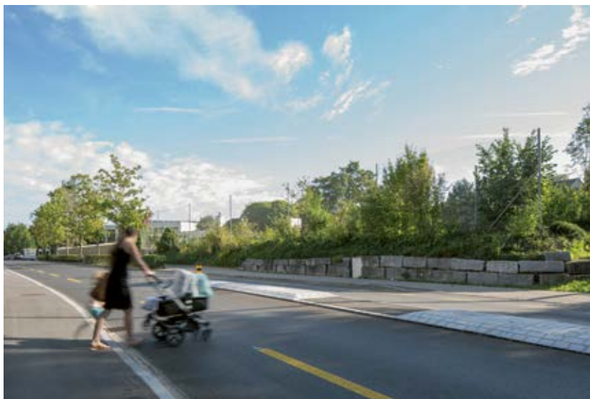
Attraversamento con isola spartitraffico, ma senza strisce pedonali.
